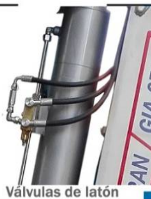
Instalación hidráulica con bandejas de plegado de latiguillos
